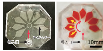
● Lab-on-a-chip 標本溶液自動分注チップ (濡れ性表面・表面張力制御技術)
